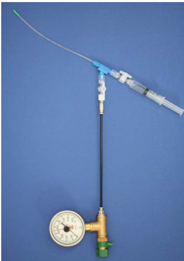
Abb. 2: Versuchsaufbau, Ballonkatheter mit Zuleitung zum Rohrfeder-Manometer und Auslassventil.
