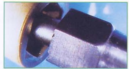
Abb. 8: Master Tool für das Finishing der Gussteile ergibt formschlüssige Passung auf der Schnittstelle.
