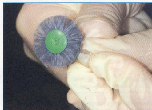
Abb. 4: Die Glättung erfolgt mit der Polyamidbürste 402-220.
