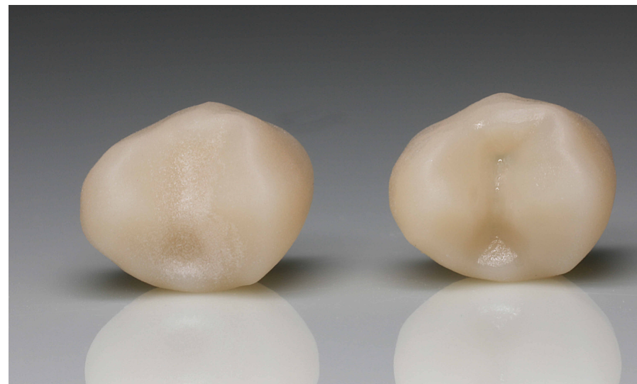
Abb. 3: Die DCS Pro 5 (rechts) liefert als 5-Achs-Maschine gegenüber einer Primemill (3 Achsen) ein deutlich detailreicheres Schleifergebnis bei besserer Oberflächenqualität.
