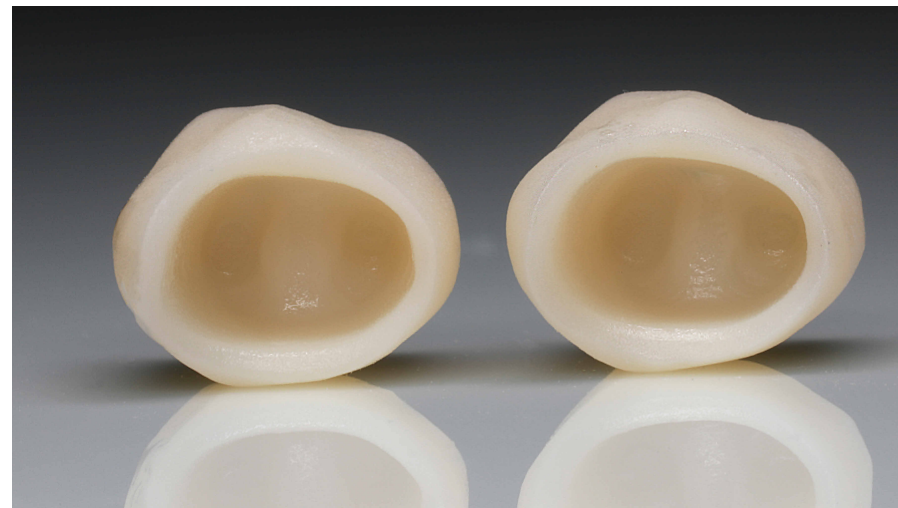
Abb. 4: Auch beim Präparationsrand sowie dem Intaglio ist die 5-Achs-Maschine im Vorteil (links Primemill , rechts DSC Pro 5 )
