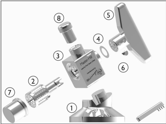
Après traitement, l'assemblage des différents éléments du Master-Mill s'effectue de la façon suivante :
