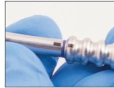
Stecken Sie den Griff in den Ratschenkopf. Durch das Drehen des Griffs im Uhrzeigersinn arretieren Sie alle Einzelteile. Die Ratsche ist erst dann voll funktionsfähig, wenn die Lasermarkierungen von Griff und Ratschenkopf genau bündig übereinander stehen.
