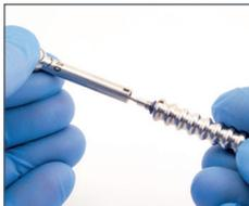
Halten Sie dabei das Zahnrad mit Daumen und Zeigefinger fest und drehen Sie den Griff mit dem Federstab gegen den Uhrzeigersinn heraus.
